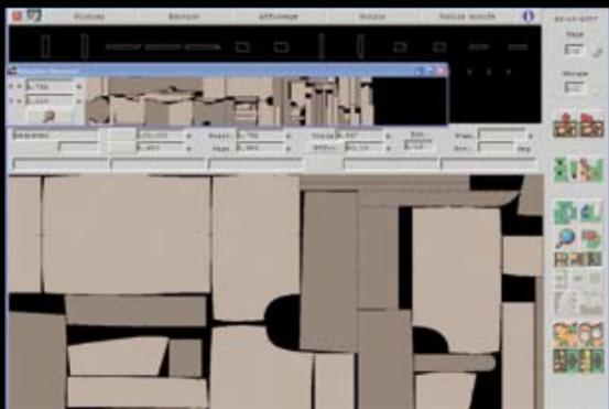
DiaminoFurniture se caracteriza por su flexibilidad, e integra la marcada automática en un proceso interactivo que ofrece la posibilidad de efectuar las marcas de forma totalmente automatizada o colocar las piezas más importantes en modo interactivo, y aprovechar después la potencia de los algoritmos en modo automático.
